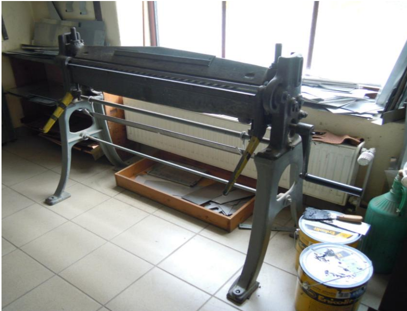
Artikel 4.1.1 Die kleine Kantebank, eines der ersten Werkzeugmaschinen von Herbert Schomer. privat Bild
